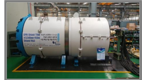
공동구 급곡구간 시공장비
