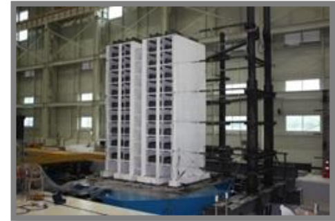
연구장비 인프라 : 공동주택모형 내진성능 시험
